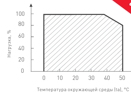
Рис. 2. Максимальная допустимая нагрузка, % от мощности источника
