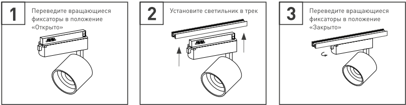
Рис. 3. Установка светильника в трек
